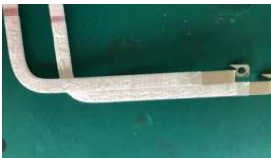
图 2 新能源汽车动力系统连接件中应用云母绝缘带(示例)
