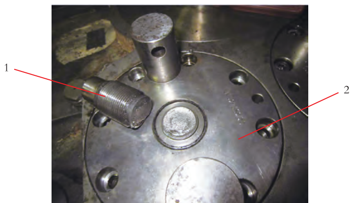
1. 活塞杆螺纹 2. B轴夹紧活塞缸 图1 加工中心B轴夹紧油缸活塞杆断裂图
