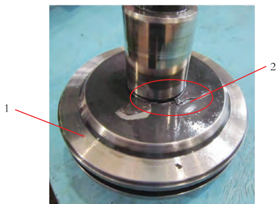
1. 油缸活塞 2. 裂纹位置 图2 加工中心B轴夹紧油缸活塞
