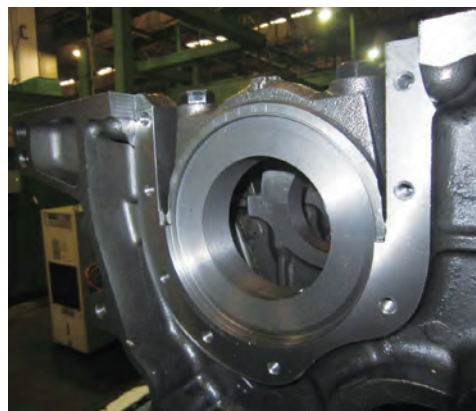
图4 柴油机汽缸体后油封挡板结合面
