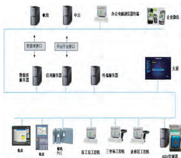
图13 信息与自动化系统架构
