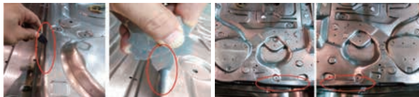
图14 拼焊板车门内板拉延模具小圆角成型过程中出现局部的严重磨损状态示意图
