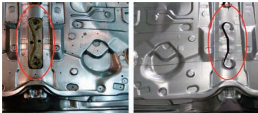
图17 拼焊板车门内板拉伸模具工艺切口刺破补料控制点状态示意图
