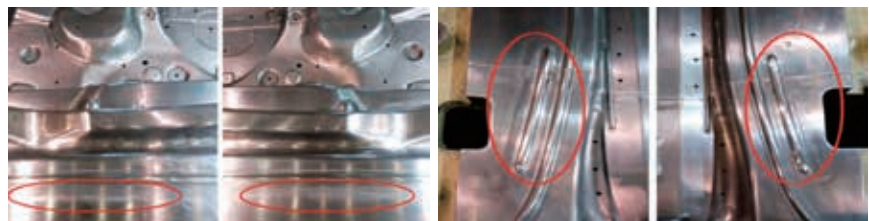
图16 拼焊板车门内板拉伸模具压料控料工艺控制点状态示意图
