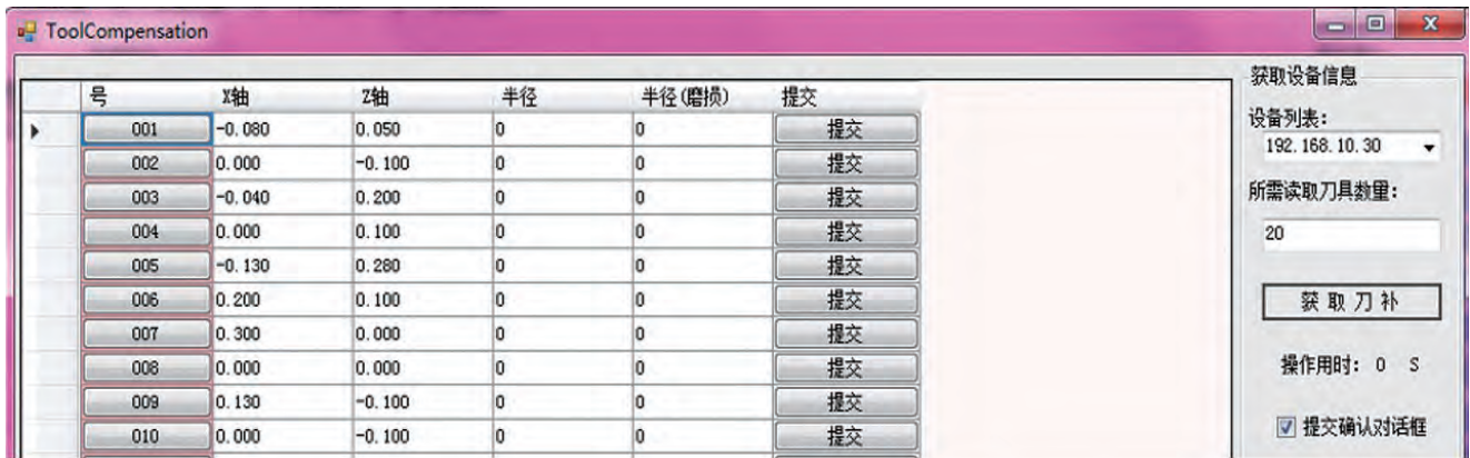
图5 客户端侧05工序车床刀具补偿数据(远程)
