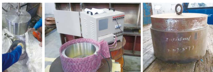
(a)前期热套试验 (b)电加热装置 (c)热套成功
