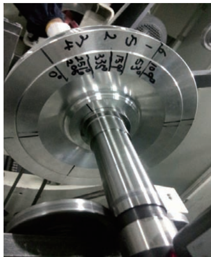
图11 用膨胀芯轴测试不平衡量
