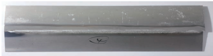
图13 Aleris Superlite 200 ST铝合金板/ST13钢板MIG搭接焊试样照片 (焊接参数: 4047实心焊丝, 焊接电流85A, 焊速70cm/min, 送丝速度5.1m/min)
