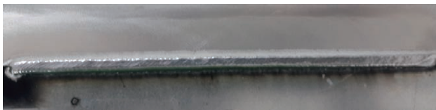
图11 Aleris Superlite 200 ST铝合金板/ST06Z镀锌钢MIG搭接焊试样照片 (焊接参数: ER4043焊丝, 焊接电流75A, 焊速70cm/min, 送丝速度4.2m/min)
