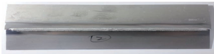
图12 Novelist AC 170 PX铝合金板/ST13钢板MIG搭接焊试样照片 (焊接参数: 4047实心焊丝, 焊接电流66A, 焊速70cm/min, 送丝速度3.4m/min)
