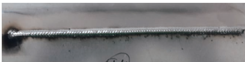
图10 Novelist AC 170 PX铝合金板/ST06Z镀锌钢MIG搭接焊试样照片 (焊接参数: ER4043焊丝, 焊接电流55A, 焊速70cm/min, 送丝速度2.5m/min)
