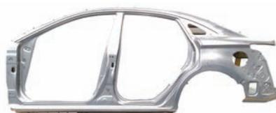
图2-1 侧围外板零件图
