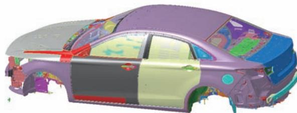
图2-3 与左右侧围外板具备匹配关系的零件图
