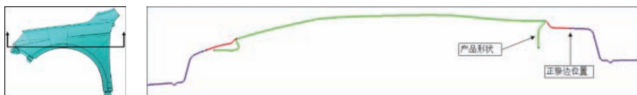
图10 翼子板深拉延工序剖视图
