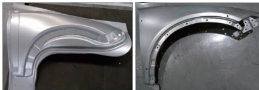
图13 A车型翼子板拉延件与产品件
