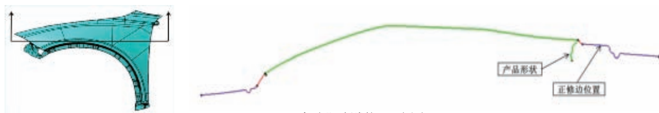
图11 A车型翼子板浅拉延工序剖视图
