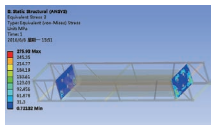
图15 竖直向下2g载荷立板应力分布图
