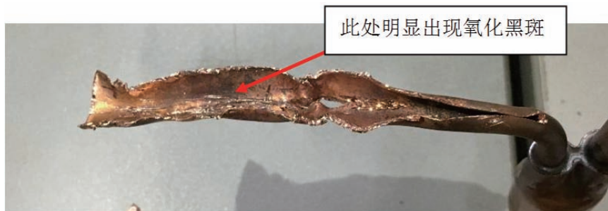
图4 使用工装前的剖开样品
