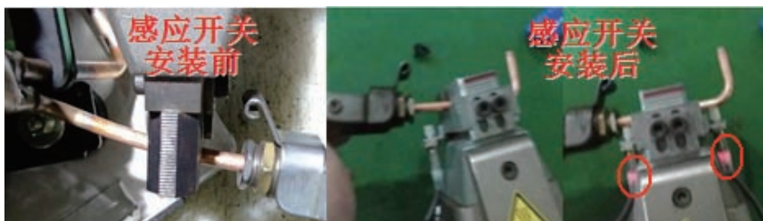
图7 金属感应开关安装前后对比
