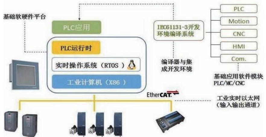
图2 整体控制网络架构设计
