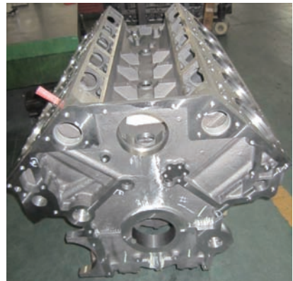
图10 加工完成后的V型气缸体
