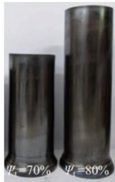
图10 Haynes230合金热强旋筒形件
