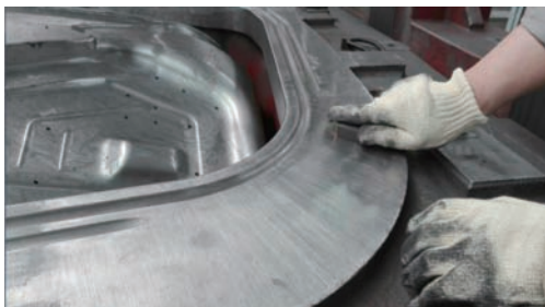
图8 粗蹭光去除刀痕
