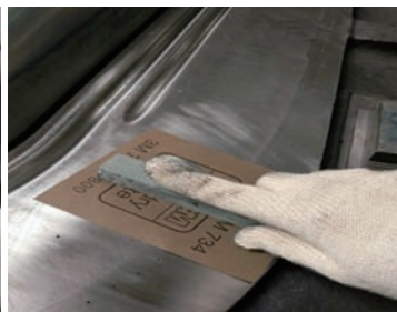
图9 精蹭光提高表面光洁度
