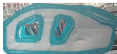
图5 压料圈研修后制件压料面着色状态
