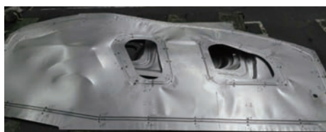
图4 压铅丝测压料面及拉延筋间隙
