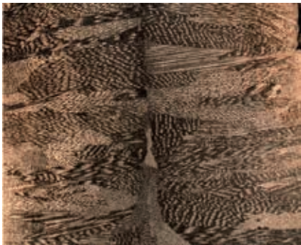
图6 焊缝组织照片
