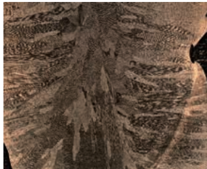
图7 焊缝中心等轴状树枝晶组织
