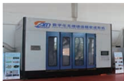
图9 无模技术制造砂芯设备示意图
