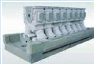
V6 柴油发动机缸体 3360mm × 1410mm × 1500mm，20 天
