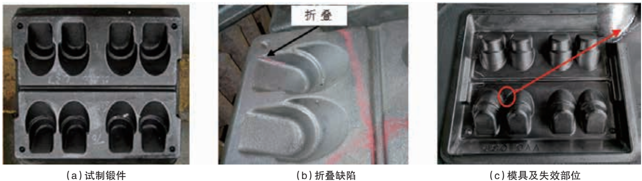
图11 试制出的锻件和锻打后的模具
