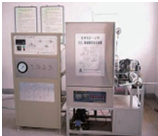
图16 超临界流体法回收PCB装置
