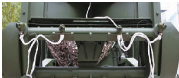
图4 雷达组件外形及安装位置图
