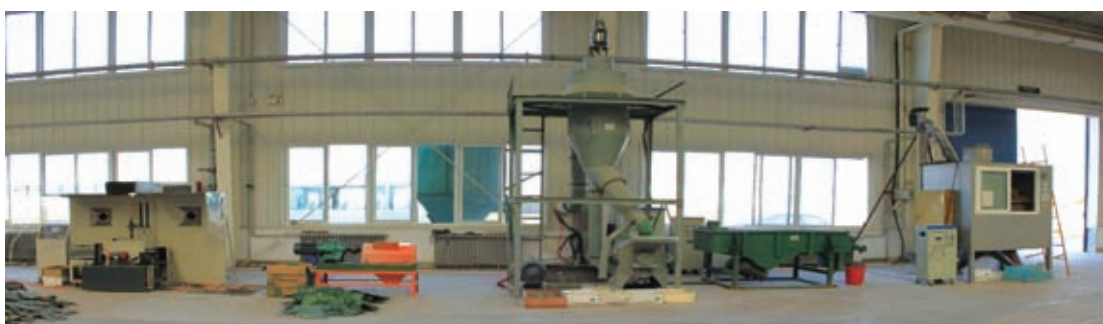
图17 线路板回收处理成套装备
