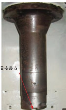
图3 原镗杆结构图
