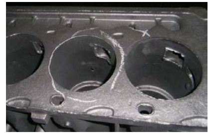
图8 五缸凸轮轴气孔
