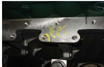
图5 底法兰框架螺孔气孔
