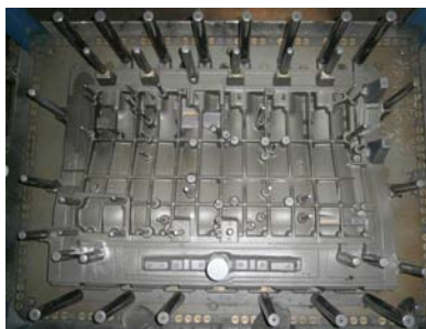
图13 36D缸体上型板更改前
