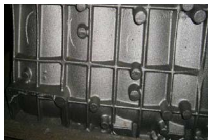
图7 上箱面前端悬置气孔
