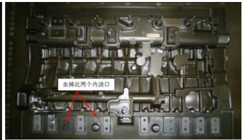
图11下型板底注内浇道更改后
