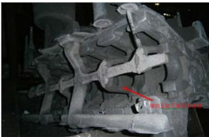
图9增加五缸下轴瓦内浇道
