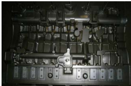
图10下型板底注内浇道更改前
