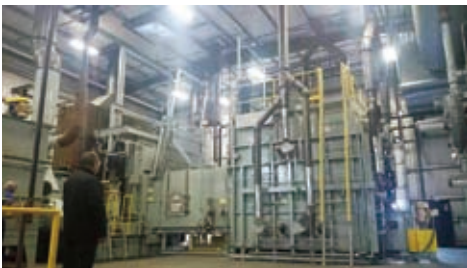
图14 安装于美国威斯康新州AP公司的UBQA 849654 (装载量9t) 等温热处理设备
