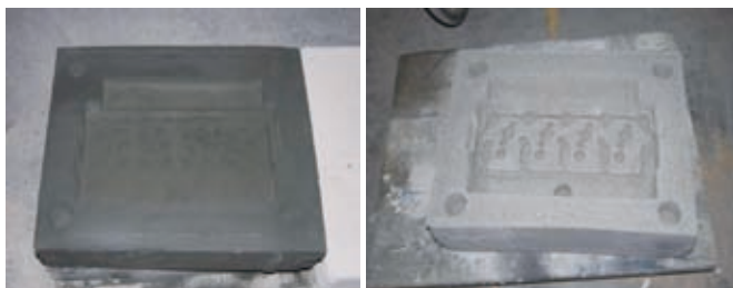
(a) 1#底座砂芯 (b) 6#盖板砂芯 图7 加工后的砂型
