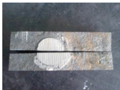
图19 发热冒口上箱取样部位，实测 555、570Mpa
