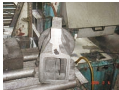
图10 支架处切口冷铁处仍有缩孔有待解决
