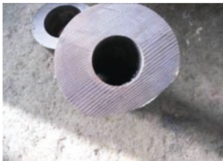
图9 法兰处切口法兰处已经无收缩倾向
