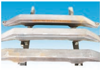
图1 60吨自卸车前轴
