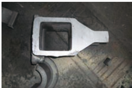
图13 支架处横向切口
