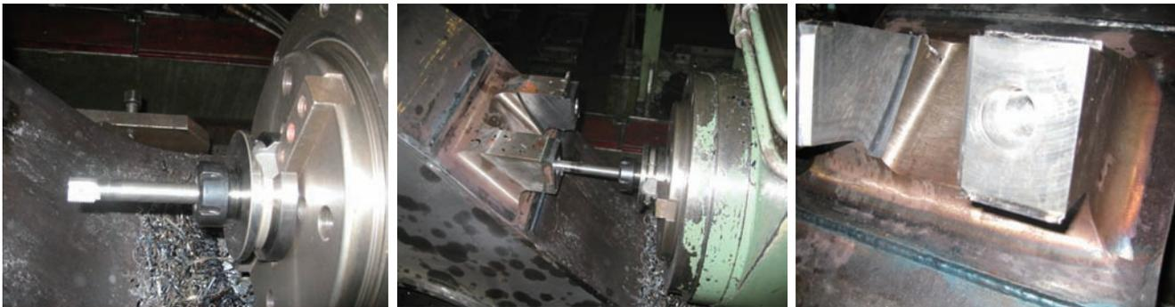
图7. 专用机夹螺纹铣刀 图8. 铣刀由孔口向孔内进行切削 图9. 已加工的M24×2螺孔
