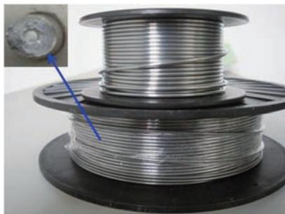
图1 无缝药芯铝焊丝
