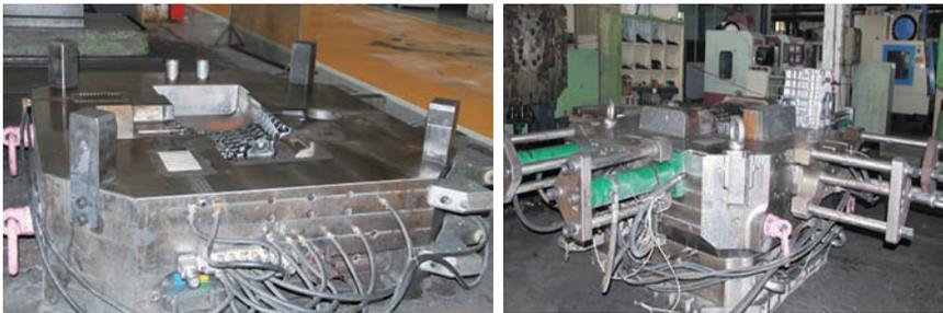
图8 重卡压铸模现场图片
