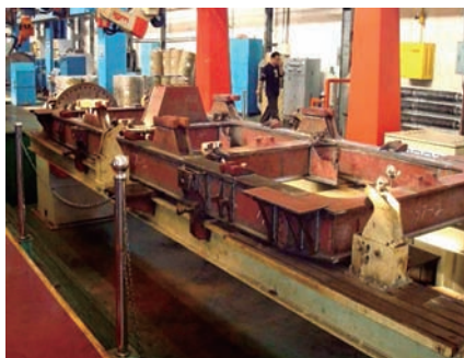
图3 构架焊接工装
