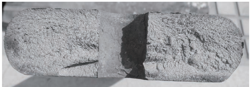
图1 中心孔脆性断裂形貌
