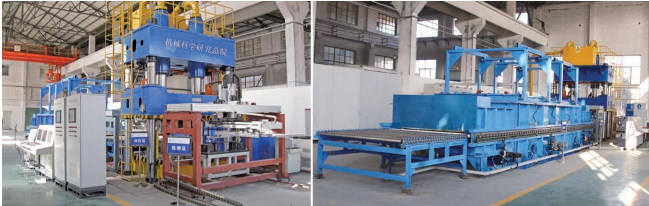
图3 基于中央控制的超高强钢热冲压自动化生产线
