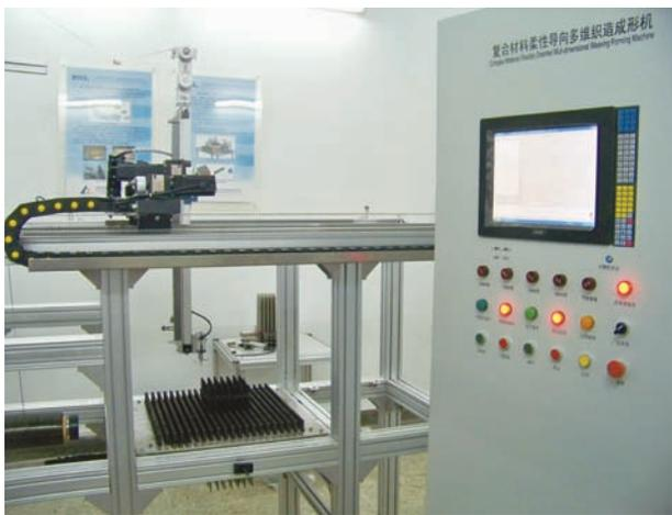
图4 复合材料柔性导向多维织造成形机
