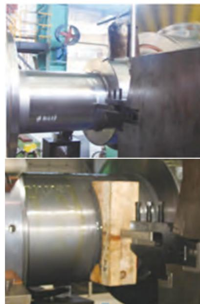
图4 F级燃气轮机转子车削加工
