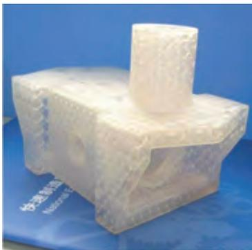
图1 某铸件的SLA树脂模
