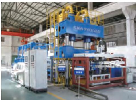
超高强钢热冲压成套技术及自动化中试线已建成国内首条具有完全自主知识产权的基于中央控制的28万件产能自动化中试线, 自主开发制造的高速高精坐标机械手可实现2件/分钟的生产节拍, 在线检具可实现实时检测零部件精度并进行在线分检。生产线厂房面积1000平米, 拥有10吨的桁吊以及完备的原料贮存、生产作业、加工检测、表面处理等功能区域, 可以完成设计开发、生产制造、模具加工、实验检测、喷砂处理、质量保障、生产储备等全生产环节。已为北汽福田批量生产供应200台迷迪新能源车型的超高强钢车门防撞梁, 并且为一汽等自主品牌开发制造电机支架、前保险杠等结构件, 产品尺寸精度达到 $\pm 0.5\text{mm}$ , 硬度分布均匀, 零部件性能达到国际先进水平。
