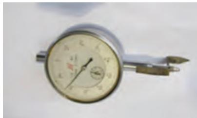
图16 检测外圆槽外侧深为9.5 mm的R3圆弧凹槽深度靠表
