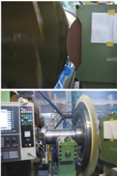
图5 F级燃气轮机转子叶顶磨削
