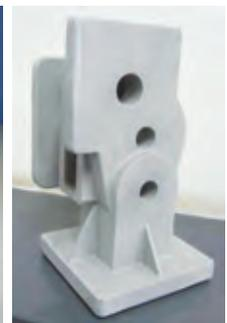
图8 铝壳体快速成型铸件（未设通风孔）
