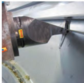
图5 加工斜槽刀具
