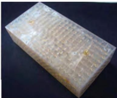
图5 型壳脱蜡后的SLA树脂模试样（内塌陷）
