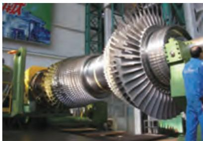
图2 F级燃气轮机转子装夹图
