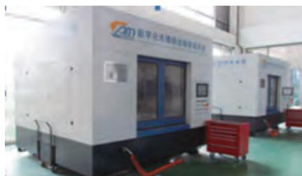
图1 数字化无模铸造精密成形机
