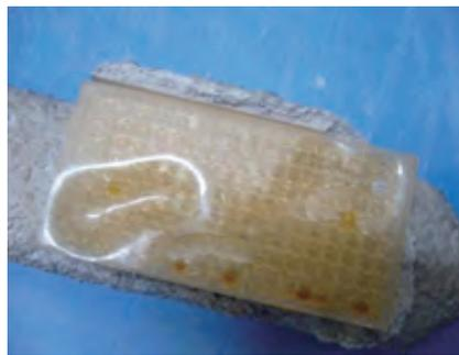
图6 直接在蒸汽脱蜡釜中加热的SLA树脂模试样（外膨胀）
